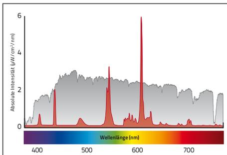
Typisches Lichtspektrum einer Energiesparlampe (Kompaktleuchtstofflampe)
