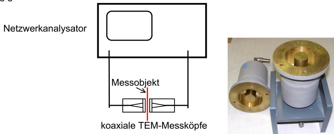
Bild 3 Messanordnung zur Ermittlung der Schirmdämpfung mit TEM-Messköpfen
