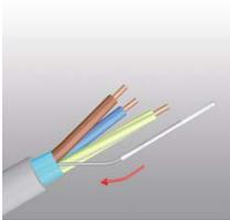
Kabel in der Gerätedose wie gewohnt abmanteln, dabei Folienschirm mit entfernen. Blanken Schirmbeidraht (SB) mit transparentem Isolierschlauch versehen (elektrisch isolieren) und 9–11 mm abisolieren.
